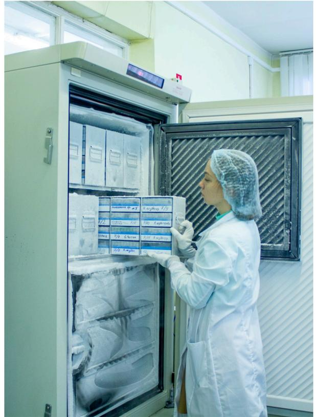
Морозильник сверхнизких температур (-86°C) “MDF-U4086S” с системой “Back-up CVK-UB2”, SANYO, Япония
