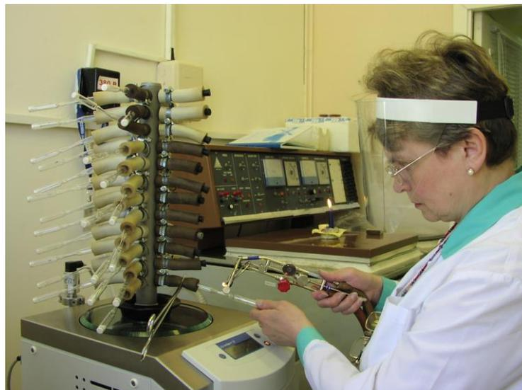
Процесс пайки ампул под вакуумом.
