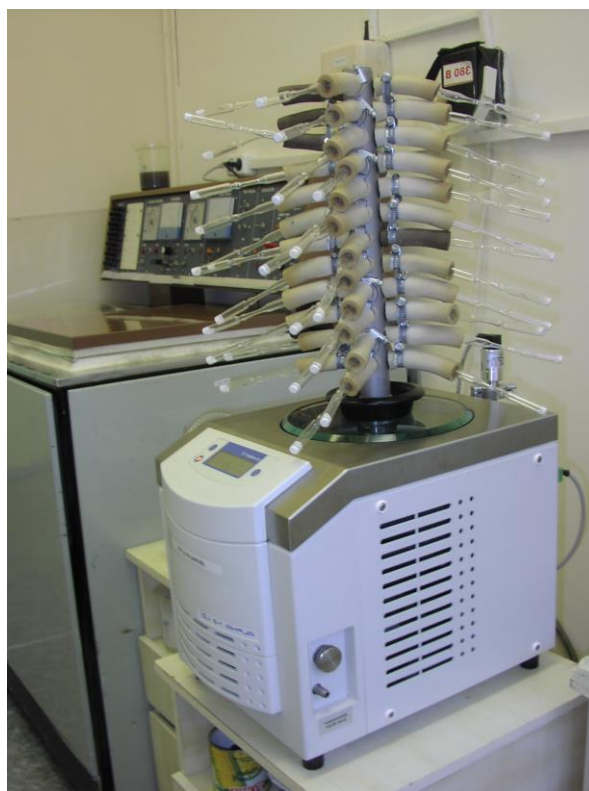
Лабораторный сублиматор OE-960 “ЛАБОР МИМ”, Венгрия (на заднем плане). Лиофилизатор Alpha 1-2 LD “CHRIST”, Германия (на переднем плане).
