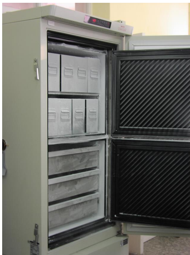
Морозильник сверхнизких температур ( -86^{\circ}\text{C} ) “MDF-U4086S” с системой “Back-up CVK-UB2”, SANYO, Япония
